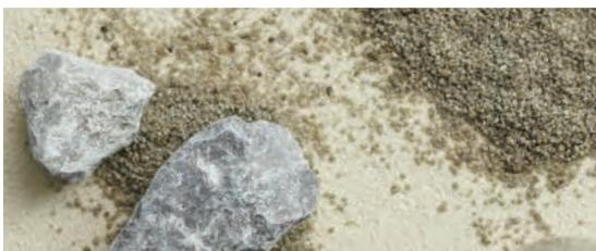
骨材に、天然の鉱物資源を原料としたガラス質の再生資源を使用。エコマークを取得した、地球環境に配慮したサステナブルな製品です。透明感のあるガラス質の骨材に、鉱物から作られる無機顔料をミックスした透明感のある美しい発色。自然素材特有の淡い濃淡が、ユニプラルSL特有の上質な風合いをつくり出します。また、有機質塗料では懸念される紫外線による色あせなどの経年劣化の心配がほとんどない、国内で数少ない無機質左官材です。
