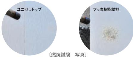
不燃性を有しているため、ユニセラトップを塗った面は燃えにくく、火災時の延焼を防ぎます。ユニセラトップは独自の燃焼試験により耐熱性・不燃性に問題がないことを確認しております。
