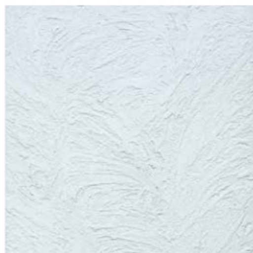
うず 木ゴテを回しながら模様を付け、金ゴテで押さえた仕上げ。 仕上厚：3mm
