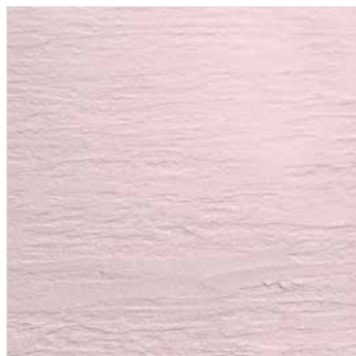
フレスコ 木ゴテを横引きにして模様をつけ、金ゴテで押さえた仕上げ。 仕上厚：3mm
