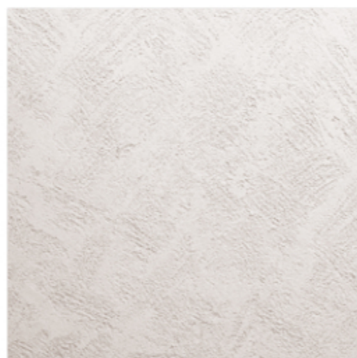
ノワ 木ゴテでクロス柄を引き、金ゴテで表面を押さえた仕上げ。 仕上厚：3mm
