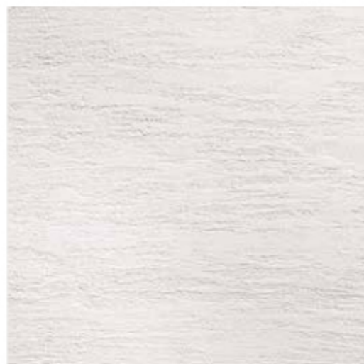
フレスコ 木ゴテで横引き模様をつけ、金ゴテで表面を押さえた仕上げ。 仕上厚：3mm
